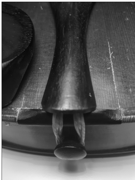
Bilde 3. Den vanligste typen tørrsprekk forekommer i lokket, på kanten av undersadelen.
