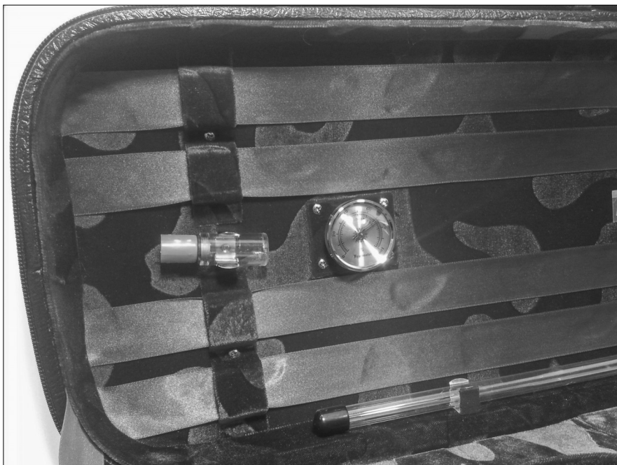
Bilde 6. Når den lille beholderen til venstre er fylt med vann, avgir den langsomt litt fuktighet inne i kassen. Til høyre ser vi et innebygd hygrometer.
